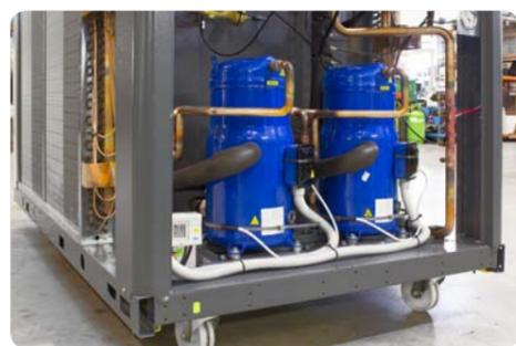
Несколько спиральных компрессоров, электронные терморегулирующие вентили, пластинчатые теплообменники, встроенное управление циркуляционными насосами и вентиляторами; все эти характерные особенности линейки **TSX** способствуют достижению высокого уровня энергоэффективности, особенно при частичных нагрузках.
