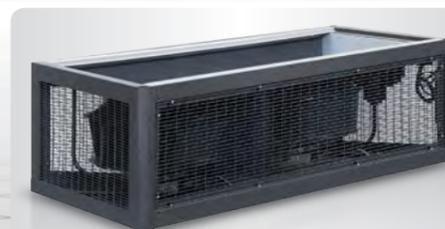
Воздух проходит через секции, увеличенные за счет установки EC-вентиляторов в базовом модуле под фальшполом, которые разделены специальной "E-Wing" перегородкой, а установленные EC-двигатели позволяют изменять расход воздуха с высокой эффективностью. Эти оригинальные технологические решения принятые на SCDR, позволяют достичь низких значений PUE.
